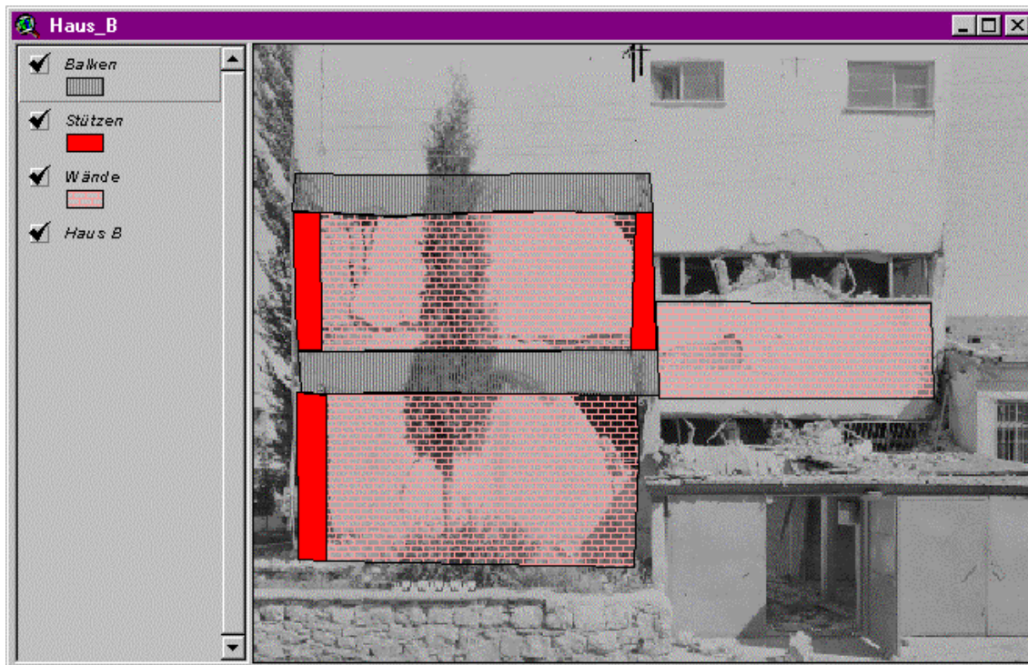
Abbildung 9: On-Screen Digitalisierung von Konstruktionselementen
