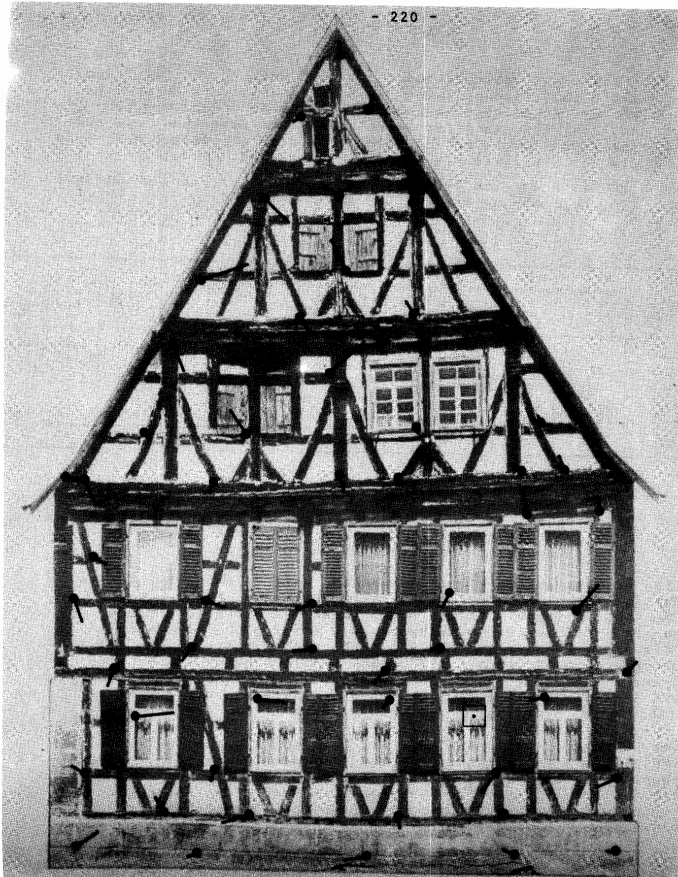
Abb. 9/8 Vektordiagramm der Restfehler nach Helmerttransformation von Orthophoto auf Stereomodell ; Objekt: Eltingen, Fachwerkhaus
