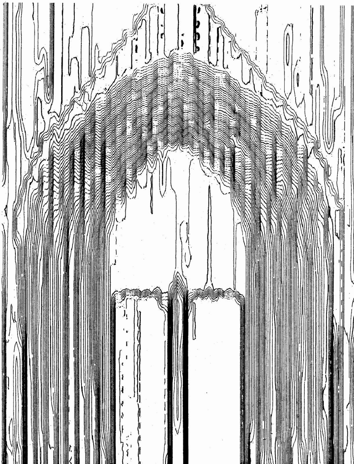
Abb. 7/2 Beispiel für direkte Schichtlinienprojektion mit dem Elektronischen Höhenlinienzeichner Zeiss HLZ
