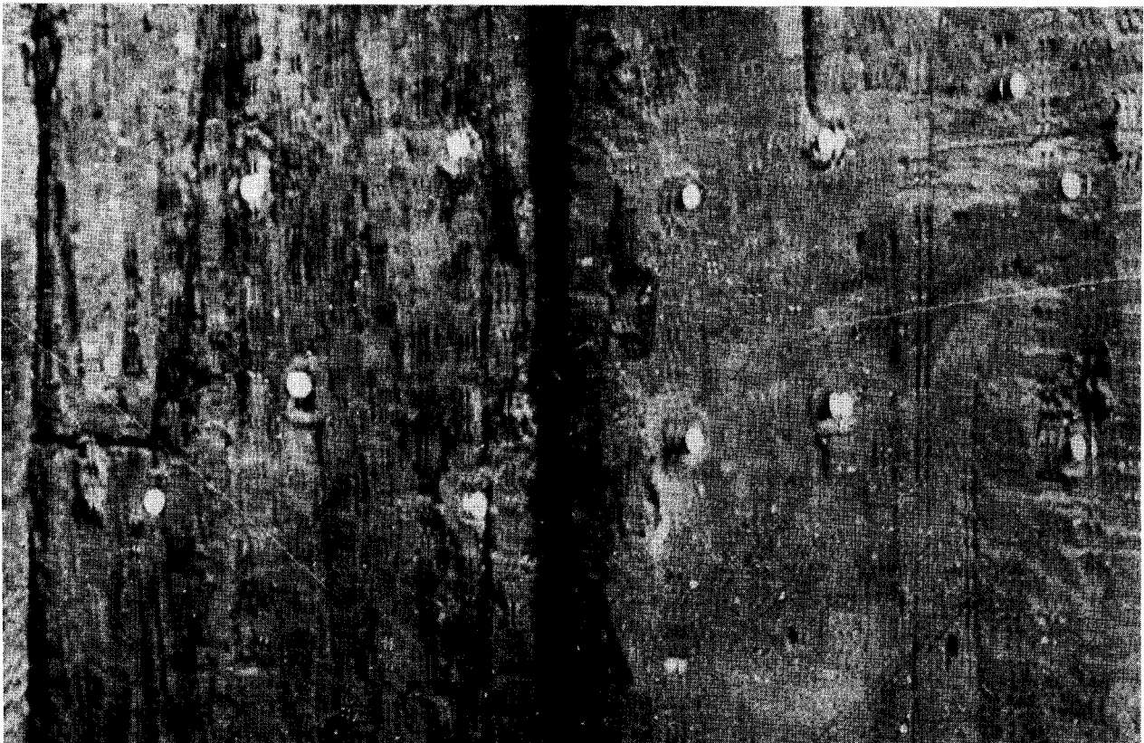
Abb. 6/6 Beispiel für Doppelabbildungen im Orthophoto an einer vom Aufnahmenadir weg geneigten Holzoberfläche; Streifenbreite \Delta x = 2 mm im Orthophotomaßstab 1:11, Ausschnittvergrößerung; Objekt : Versunkener Schiffsrumpf, Außenansicht
