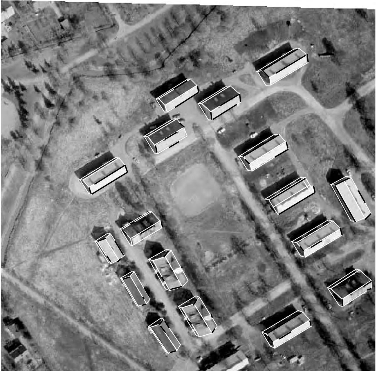
Abbildung 7.7: Stereobildpaar mit den rekonstruierten Gebäuden als Drahtmodelle und den genutzten linearen Segmenten für den Datensatz *Hochhaus* (linkes Bild).
