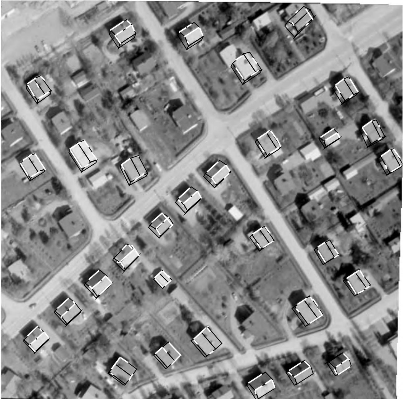
Abbildung 7.3: Stereobildpaar mit den rekonstruierten Gebäuden als Drahtmodelle und den genutzten linearen Segmenten für den Datensatz *Vorort* (linkes Bild).
