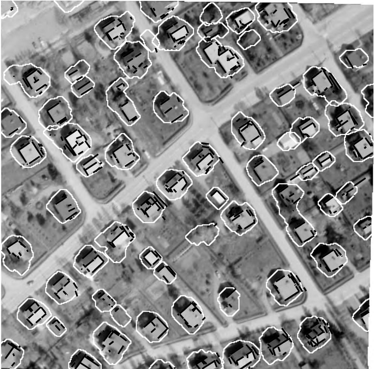
Abbildung 7.1: Gebäudehypothesen (lokale Höhenmaxima) und extrahierte lineare Segmente für den Datensatz *Vorort* (linkes Bild).
