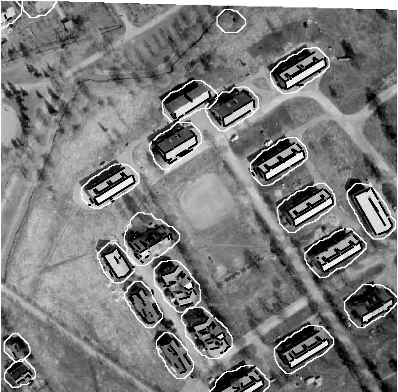
Abbildung 7.5: Gebäudehypothesen (lokale Höhenmaxima) und extrahierte lineare Segmente für den Datensatz *Hochhaus* (linkes Bild).
