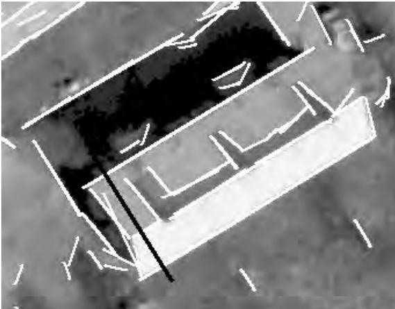
Abbildung 3.1: Bildausschnitt mit extrahierten Kanten (weiß) und abgegriffene Profillinie (schwarz).
