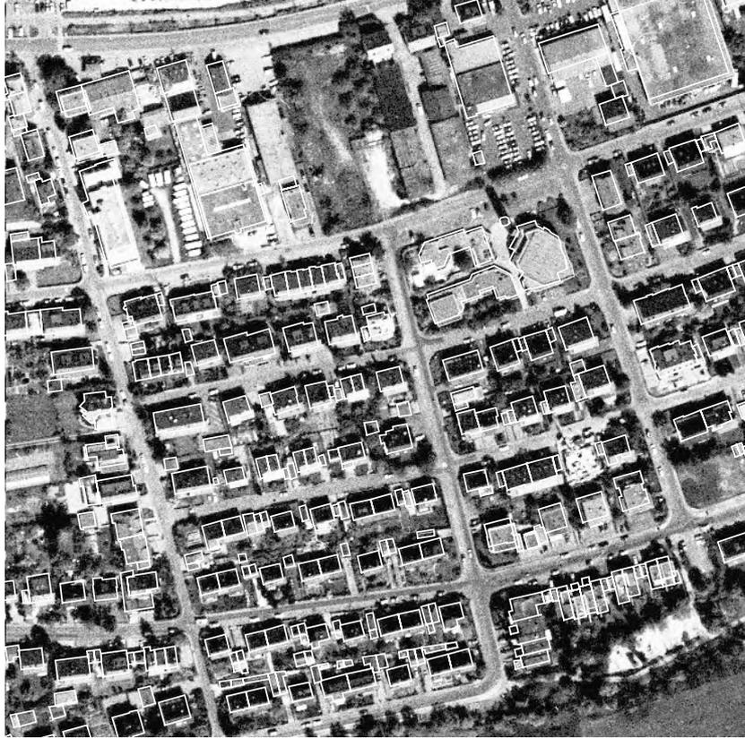
Abbildung 8.2: Bildausschnitt mit Gebäudegrundrissen aus der ALK.
