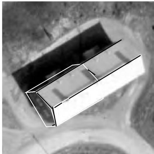
Abbildung 7.24: Beispiel für eine falsche Rekonstruktion durch Fehlzuordnungen extrahierter Linien.
