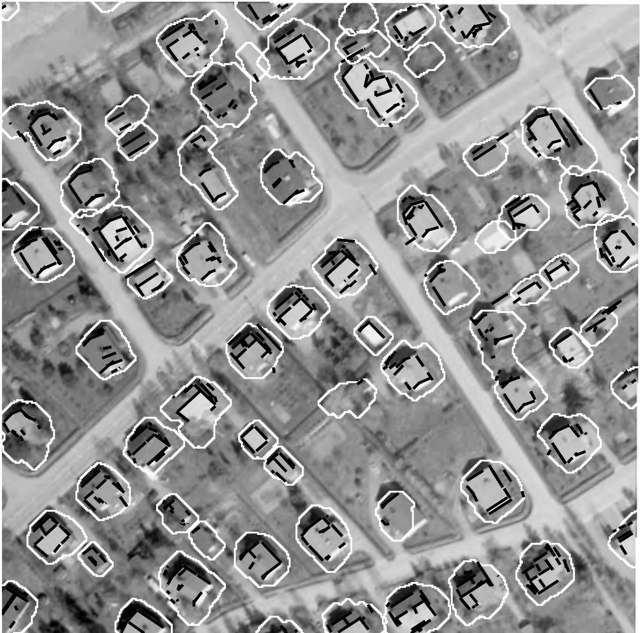
Abbildung 7.2: Gebäudehypothesen (lokale Höhenmaxima) und extrahierte lineare Segmente für den Datensatz *Vorort* (rechtes Bild).
