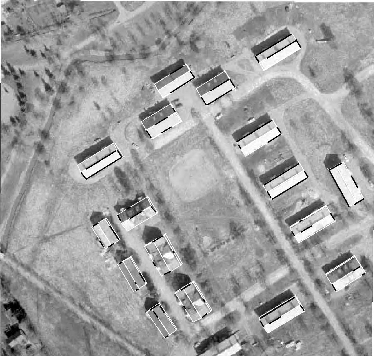
Abbildung 7.8: Stereobildpaar mit den rekonstruierten Gebäuden als Drahtmodelle und den genutzten linearen Segmenten für den Datensatz *Hochhaus* (rechtes Bild).
