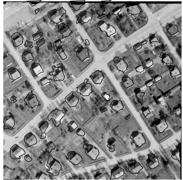
Abbildung 4.2: Bildausschnitt mit detektierten Gebäudehypothesen.
