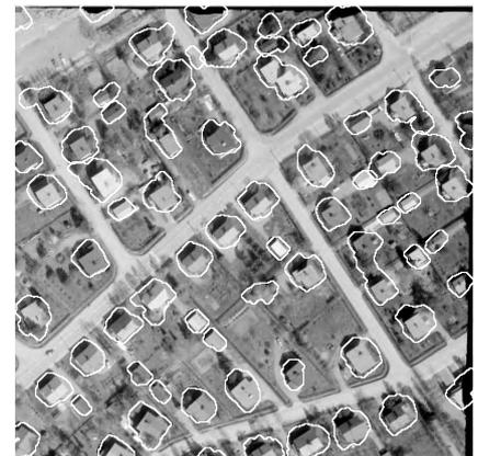
Abbildung 4.5: Bildausschnitt mit detektierten Gebäudehypothesen.
