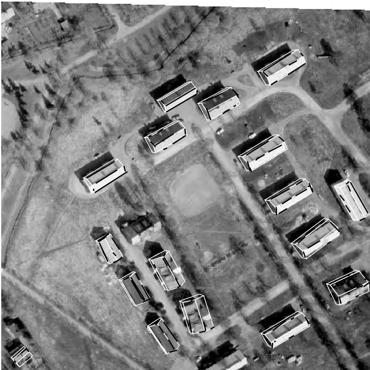
Abbildung 7.20: Rekonstruktion durch extrahierte DHM-Bruchkanten für den Datensatz *Hochhaus*.
