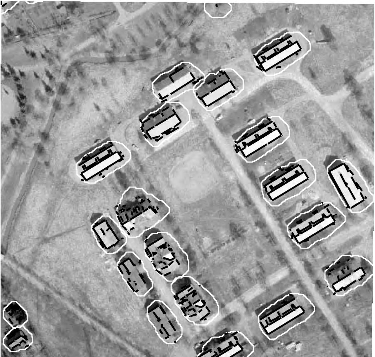
Abbildung 7.6: Gebäudehypothesen (lokale Höhenmaxima) und extrahierte lineare Segmente für den Datensatz *Hochhaus* (rechtes Bild).
