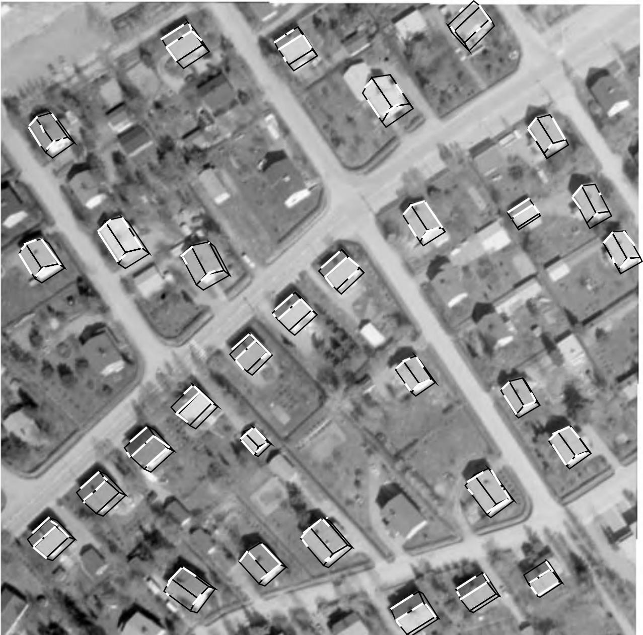
Abbildung 7.4: Stereobildpaar mit den rekonstruierten Gebäuden als Drahtmodelle und den genutzten linearen Segmenten für den Datensatz *Vorort* (rechtes Bild).
