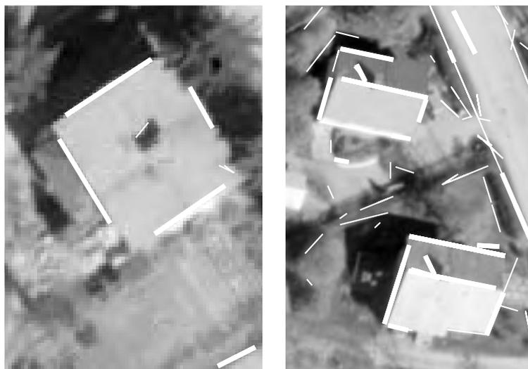
Abbildung 4.10: Extrahierte Geradensegmente (dünne Linien) und detektierte Parallelen (breite Linien).
