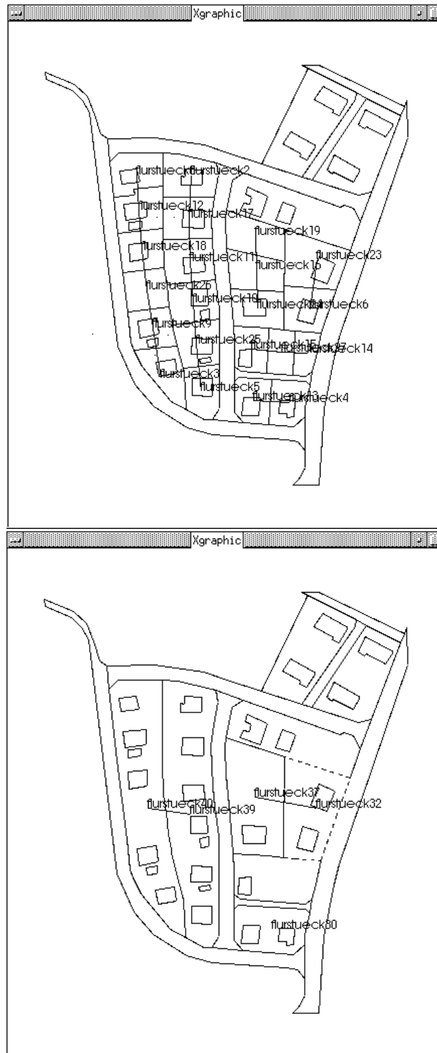
Abbildung 10.8: Flurstücke, die Relation flur-flur teilen (links); Aggregation von Objekten (rechts)
