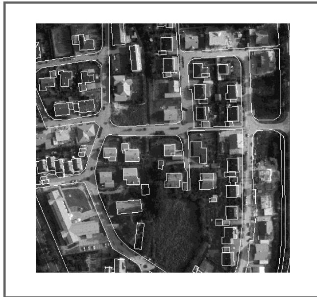
Abbildung 1.2: Bild mit überlagerten Haus- und Straßengrenzen - Eingabe für das System sind diese überlagerten Daten
