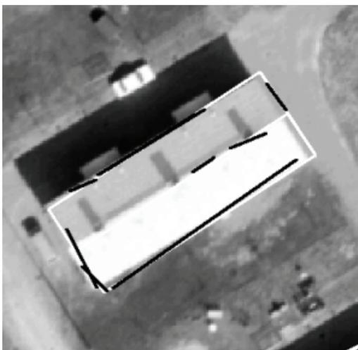
a) näherungsweise Rekonstruktion aus DOM-Kanten
