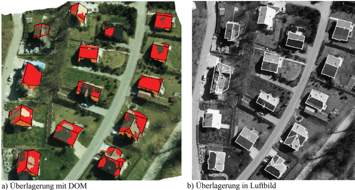
Abbildung 3-22: Ergebnis der automatischen 3D Gebäuderekonstruktion.
