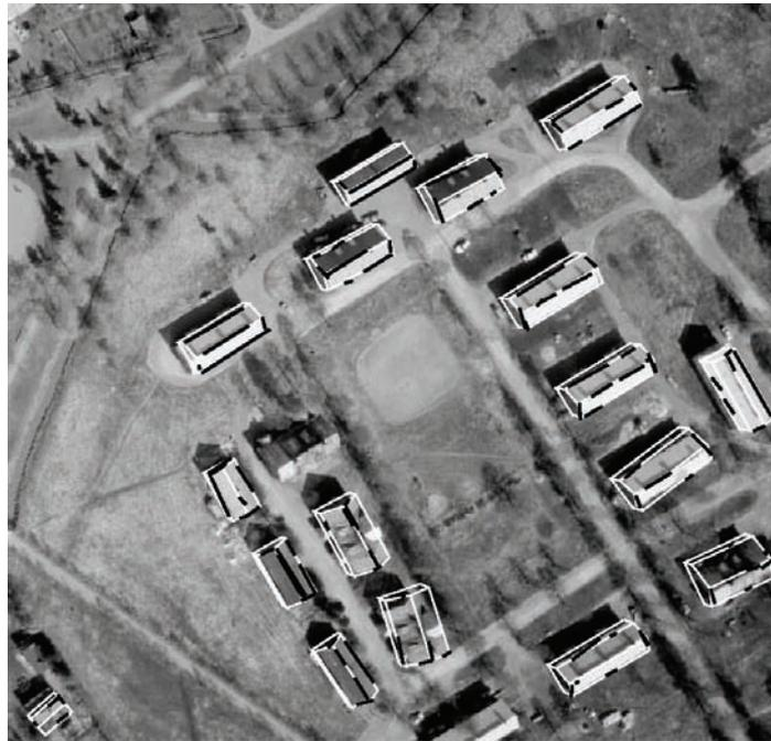
Abbildung 3-17: Gebäuderekonstruktion aus DOM-Bruchkanten.
