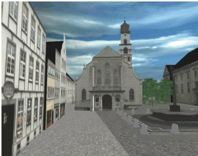
d) Visualisierung eines Platzes aus der Fußgängerperspektive. Für diese Darstellung wurde eine Texturierung der Fassaden durch terrestrische Bilder sowie die eine manuelle Verfeinerung der Gebäudegeometrien und Integration zusätzlicher Objekte durchgeführt.
