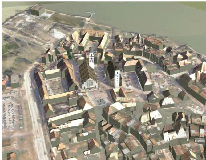
c) Visualisierung eines Stadtteils durch eine erhöhte Schrägaufnahme mit Entfernungen von 200m bis 5m. Zusätzliche Texturierung einzelner Fassaden durch terrestrische Bilder.
