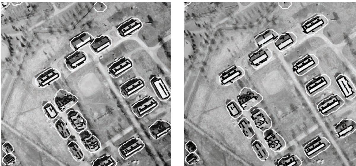
Abbildung 3-18: Stereobildpaar mit extrahierten Grauwertkanten.
