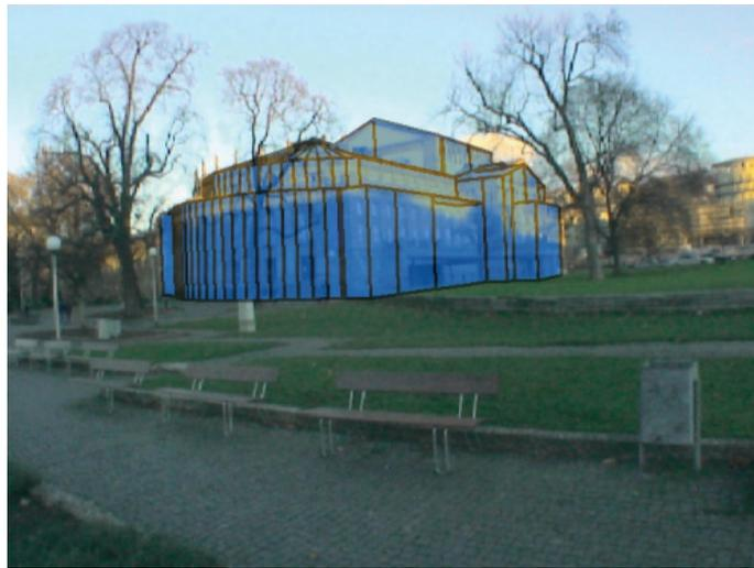
Abbildung 5-10: Automatisch eingepasstes Gebäudemodell.
