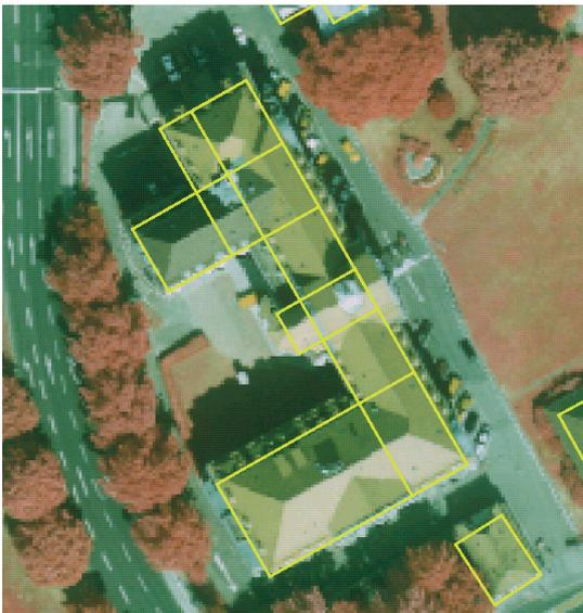
Abbildung 4-14: Rechteckzerlegung des Grundrisses.
