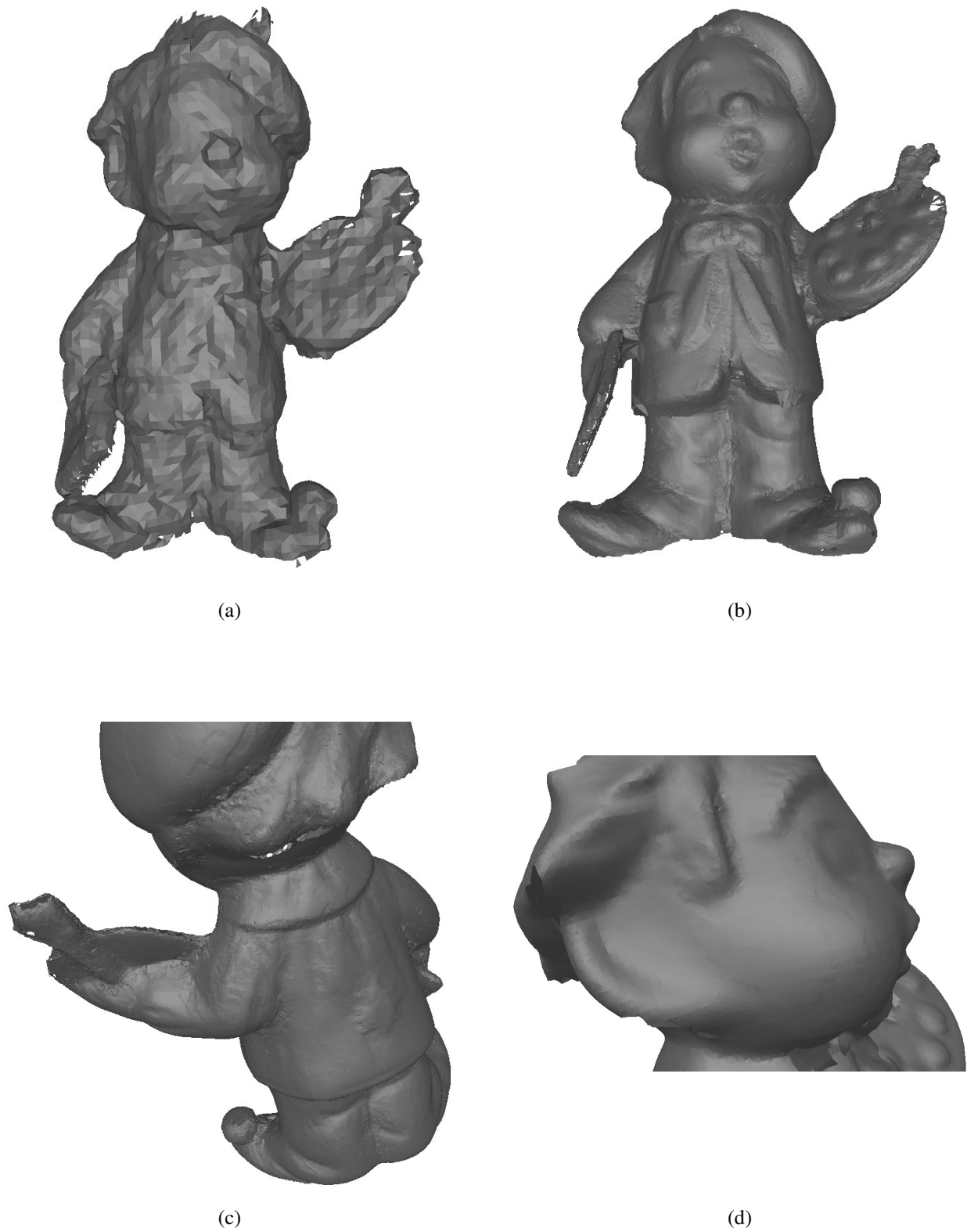
Abbildung 105: (a) Ergebnis der Topologierekonstruktion. (b) Ergebnis der Netzverdichtung. (c), (d) Detailaufnahmen des rekonstruierten Objekts.
