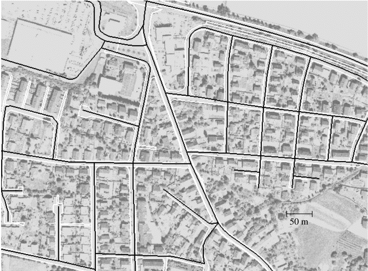
Abb. 3.7: Überlagerung der Beispieldatensätze für die Ableitung der Unsicherheit von ATKIS-Straßen (dunkel) aus ALK-Flurstücken (hell). Hinterlegt ist das zugehörige Orthophoto.
