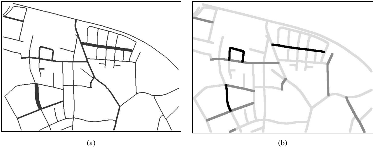
Abb. 3.13: Visualisierungen der objektindividuellen Unsicherheitswerte am Beispiel von ATKIS-Straßenobjekten: als darstellbares Attribut mit Hilfe der Linienstärke (dünne Linie = geringe Unsicherheit, dicke Linie = große Unsicherheit) (a) und Visualisierung der Einhaltung der geforderten Lageunsicherheit durch Grauwerte (schwarz: nicht eingehalten (entspricht rot), dunkel: kritischer Bereich (entspricht gelb), hell: eingehalten (entspricht grün)) (b).
