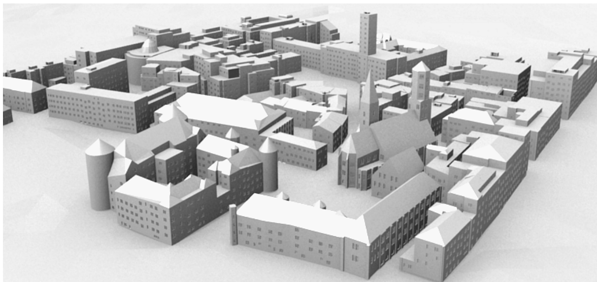
(a) 3D-Fassadenmodelle als Ergebnis grammatikbasierter Rekonstruktion
