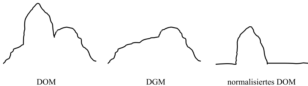
Abbildung 2.2: Zur Definition des digitalen Oberflächen- (DOM) und digitalen Geländemodells (DGM).
