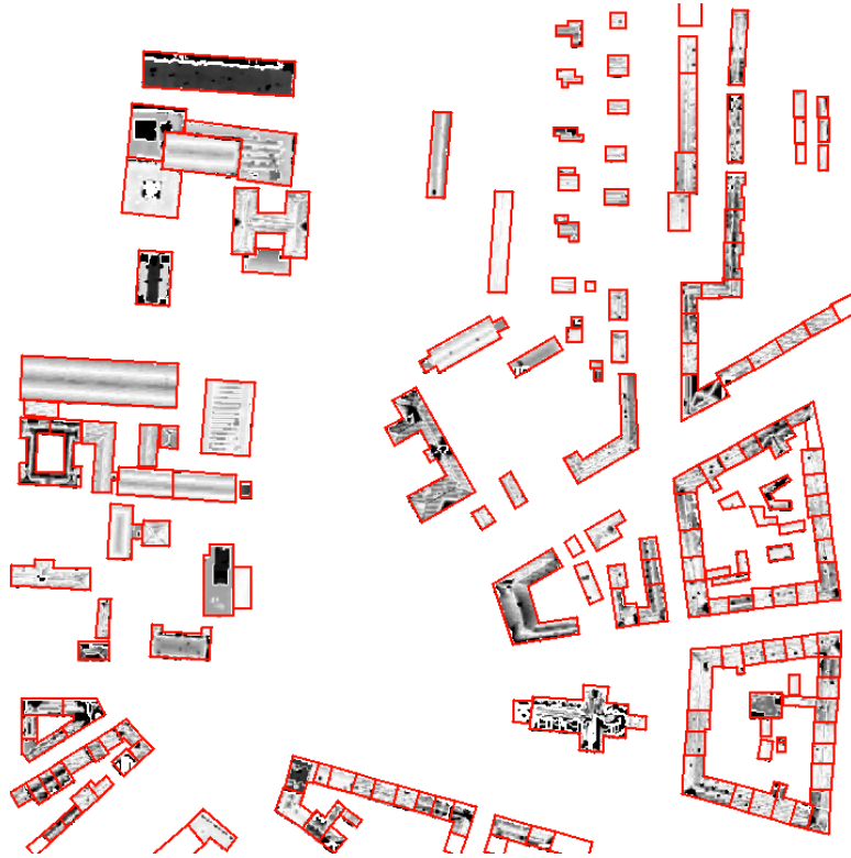
Abbildung 5.15: Differenzbild für den Datensatz "Karlsruhe", automatische Rekonstruktion. Gezeigt ist der Betrag der Abweichung |\Delta z_i| des DOM von der rekonstruierten Fläche. Der dargestellte Wertebereich ist von 0 m (weiß) bis 3 m (schwarz).
