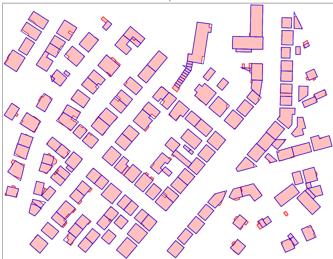
Abbildung 8.7: a) generalisierter Datensatz, b) angepasst an den Grundriss
