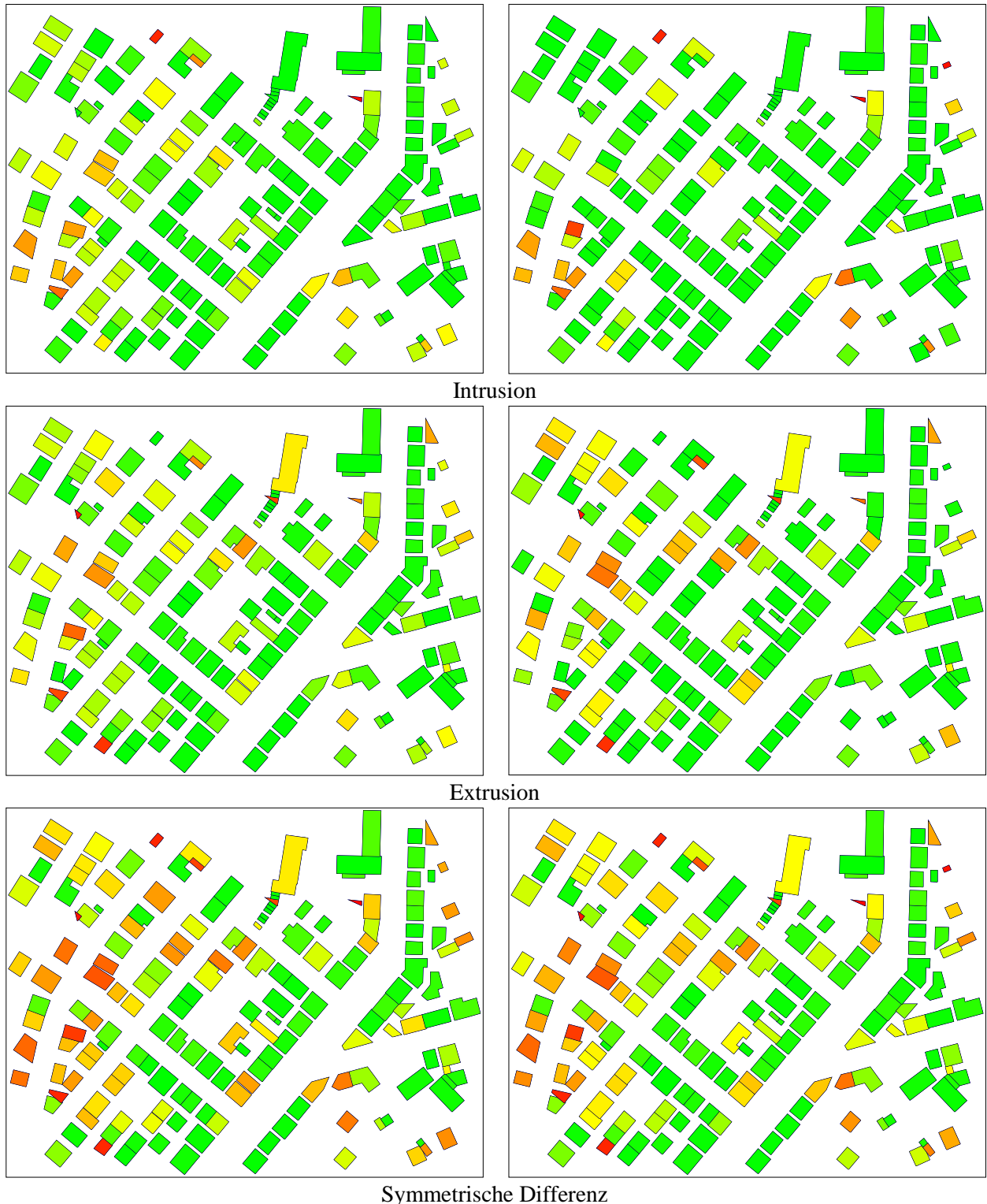
Abbildung 8.17: Flächenbezogene Qualitätscharakteristiken der generalisierten (links) und angepassten (rechts) Grundrisse
