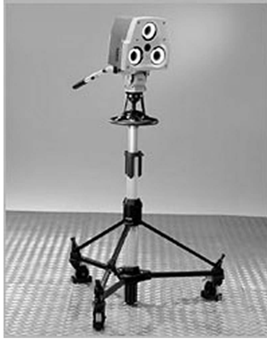
Abbildung 2.2: Sensorsystem mit Musterprojektion und drei Kameras der Firma CogniTens.
