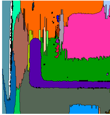
Abbildung 4.1: Beispiel für eine Segmentierung durch Gruppierung der Abtastzeilen aus Brenner und Fritsch (1997). Es sind linienhafte Artefakte sichtbar, die durch das Verfahren hervorgerufen werden.
