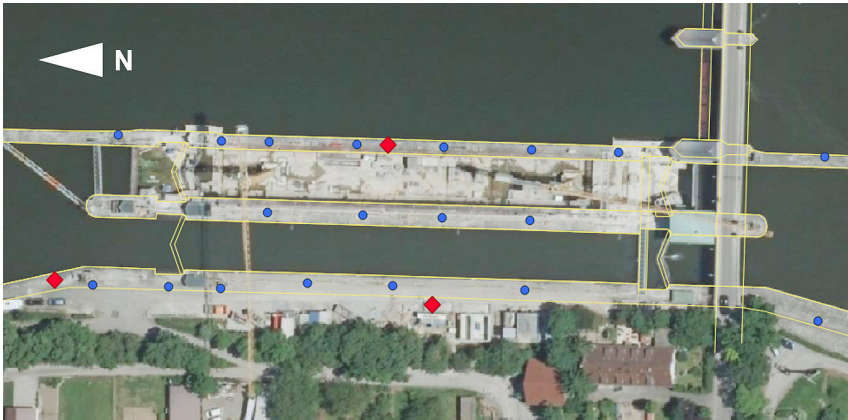
Abb. 2: Testfeld Schleusenanlage Hessigheim. Alle Punkte sind mit luft sichtbaren Schachbretttafeln signalisiert. Die drei gesondert in rot gekennzeichneten Punkte sind zudem Messpfeiler des Bauwerksnetzes.
