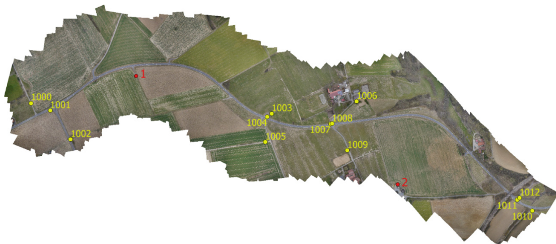
Abb. 1: Übersicht über das erfasste Gebiet mit Verteilung der Referenzpunkte (rot: Standpunkte für die GNSS-Referenzstationen, gelb: unabhängige Kontrollpunkte (natürliche Punkte))
