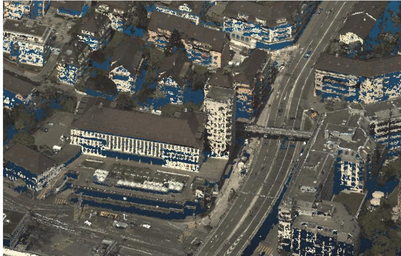
Abb. 6: Mit Bildzuordnung generierte Punktwolke aus Schrägluftbildern
