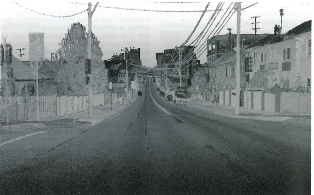
Abb. 4: Typische Punktwolke des Mobile Mapping „auf der Straße“
