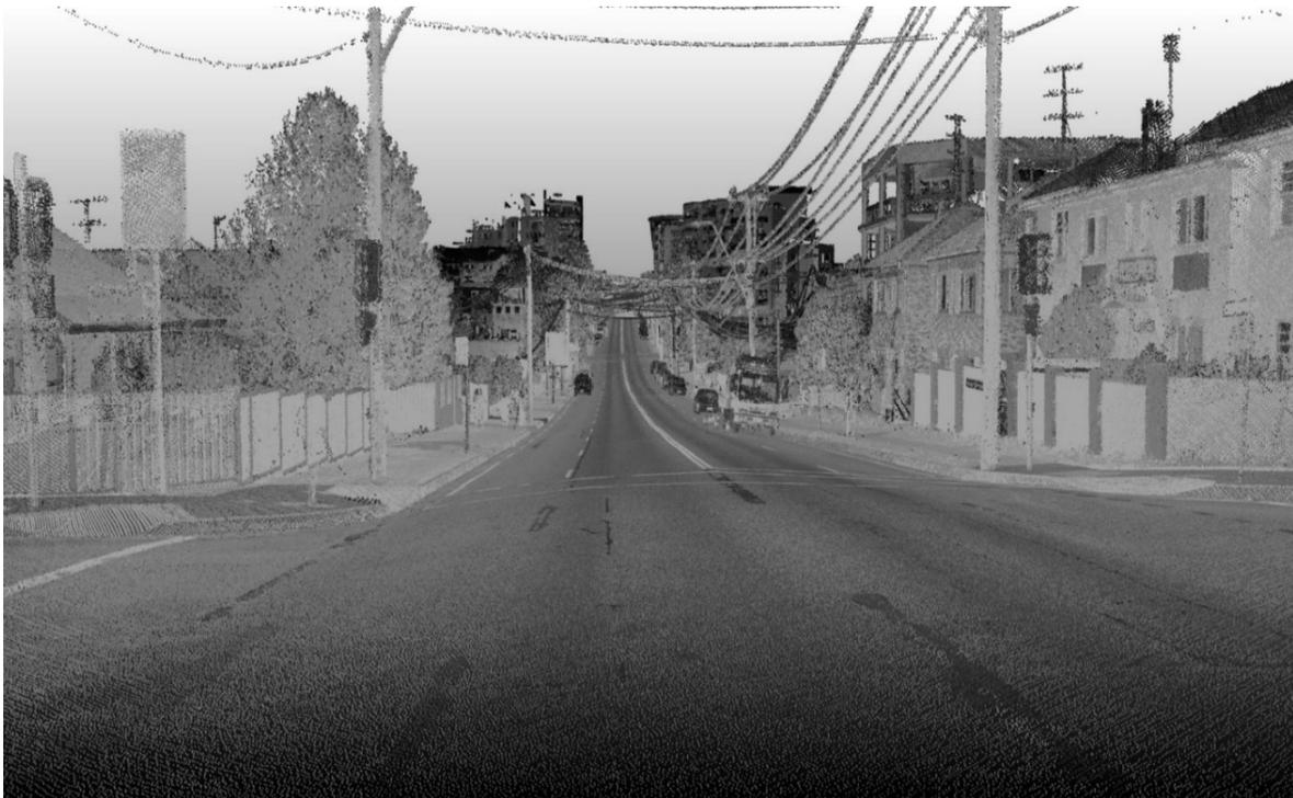
Abb. 2: Typische Punktwolke des Mobile Mapping „auf der Straße“
