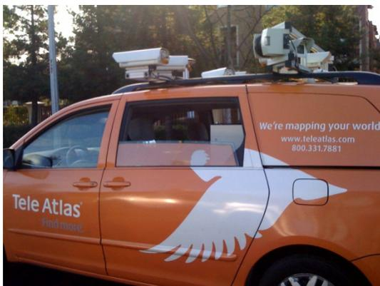
Abb. 8: Bildbasierte Mobile Mapping-Systeme
