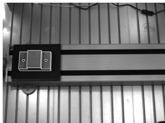
Abb. 2: detektierter Versuchskörper mit eingeblendetem CAD-Modell
