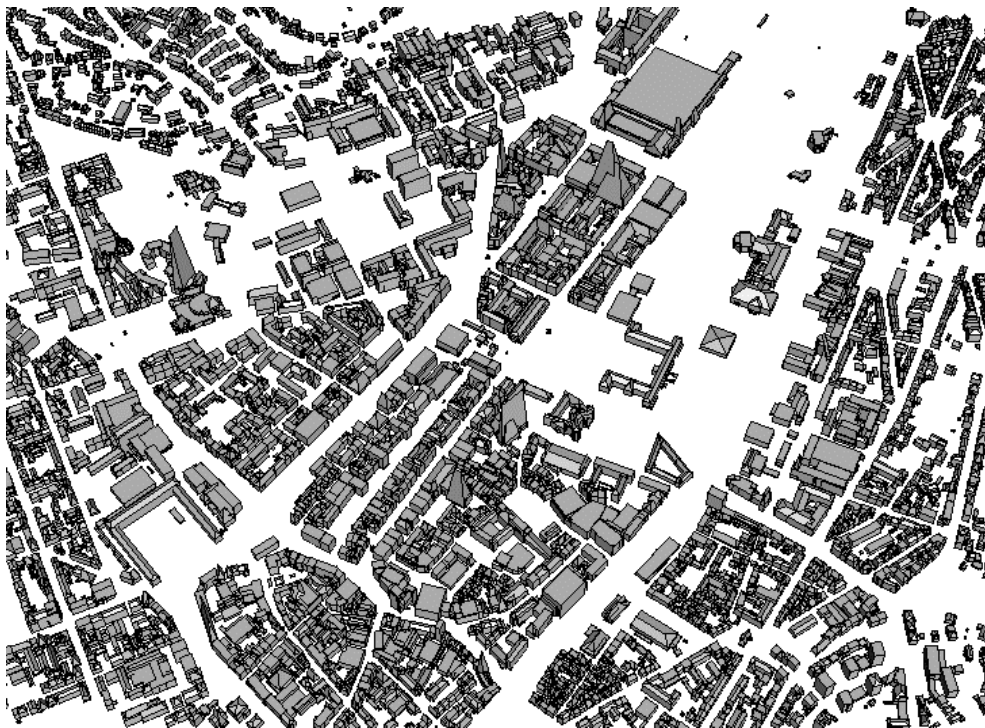
Abb. 6: Ergebnis der automatischen Gebäuderekonstruktion
