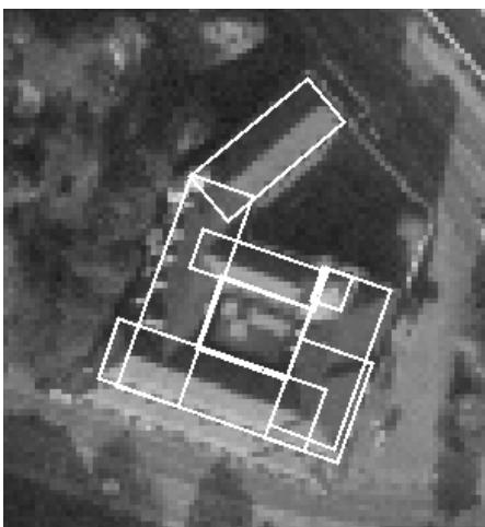
Abb. 2: Rechteckzerlegung des Grundrisses
