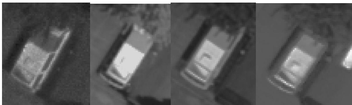
RMK Dichte ca. 1.6 DMC DN=3445 UC DN ca. 9500 Digicam DN ca. 62'000
