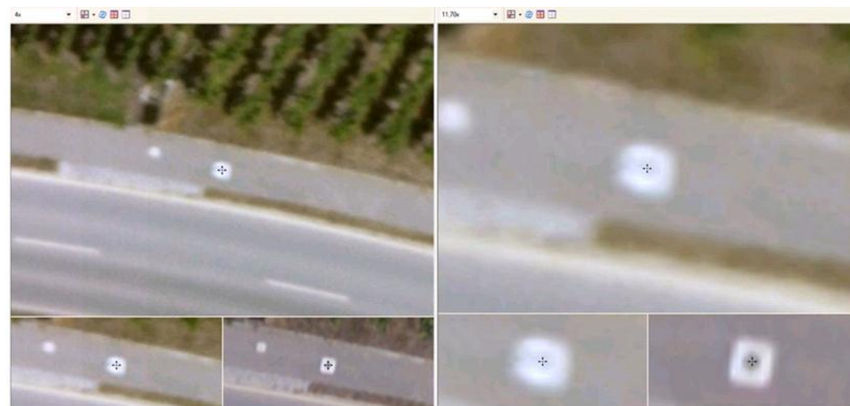
Passpunkt Nr. 3041029 in Zoom-Stufe 4x (links) und 11,7x (rechts). Unten: jeweiliger Stereopartner.
