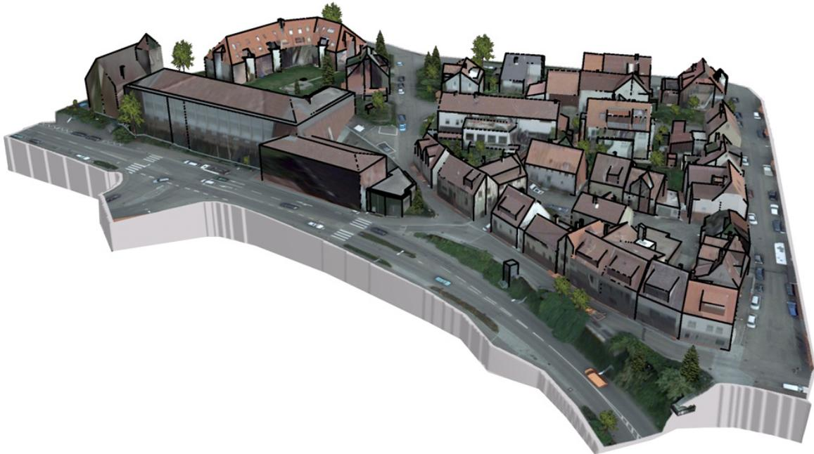
Abb. 1: 3D-Ansicht der photogrammetrischen Auswertung, Gebiet 1 „Innenstadt“, in den Bildern der UltraCamX, 8cm Ground Sampling Distance (GSD).
