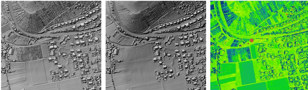
Abb. 4: DOM aus Bildzuordnung (links) und LiDAR (Mitte) und berechnete Differenzen (rechts)
