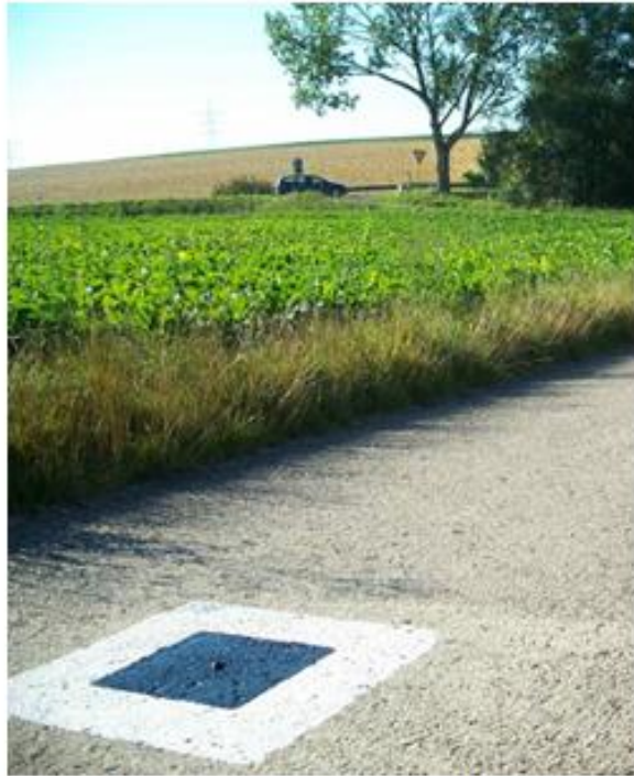
Punkt Nr. 3006 signalisiert mit Farbmarkierung auf Feldweg im zentralen Testfeldbereich.
