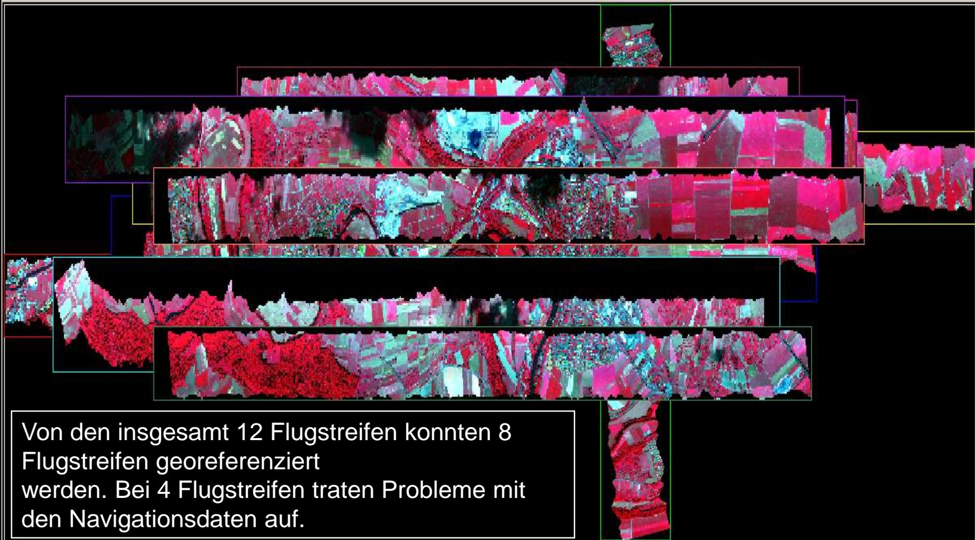
Von den insgesamt 12 Flugstreifen konnten 8 Flugstreifen georeferenziert werden. Bei 4 Flugstreifen traten Probleme mit den Navigationsdaten auf.
