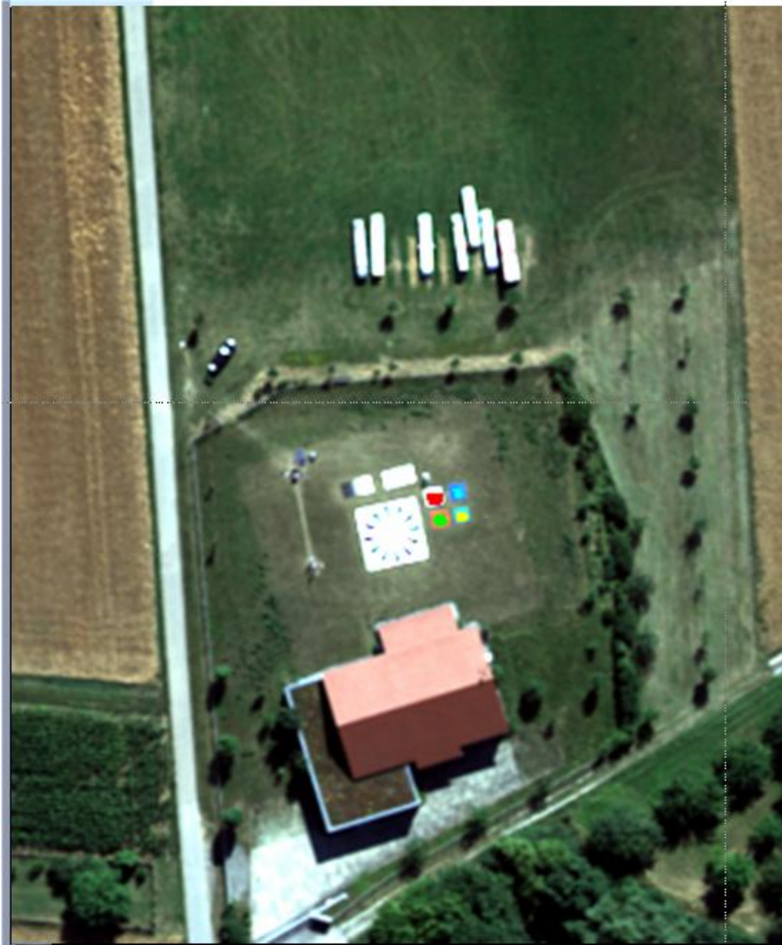
Abb. 2: Radiometriefeld mit Siemensstern, farbigen Planen und Bodenmessgeräten (Die farbigen Kleckse innerhalb der Farbplänen kennzeichnen das Mittelungsintervall bei der späteren Auswertung)
